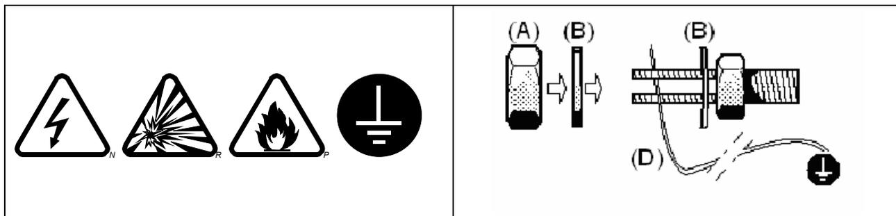
Desenroscar la tuerca de bloqueo (A), pasar entre las arandelas (B) la extremidad de un hilo de tierra (D) (sección mínima : 1,5 mm<sup>2</sup>) en el agujero del terminal. Apretar la tuerca de bloqueo (A). Conectar la otra extremidad del hilo a una verdadera "tierra" en conformidad con la reglamentación local.
